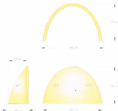
KOMORA DRENAŻOWA MC-3500 WIDOK (BEZ ZACHOWANIA SKALI)
